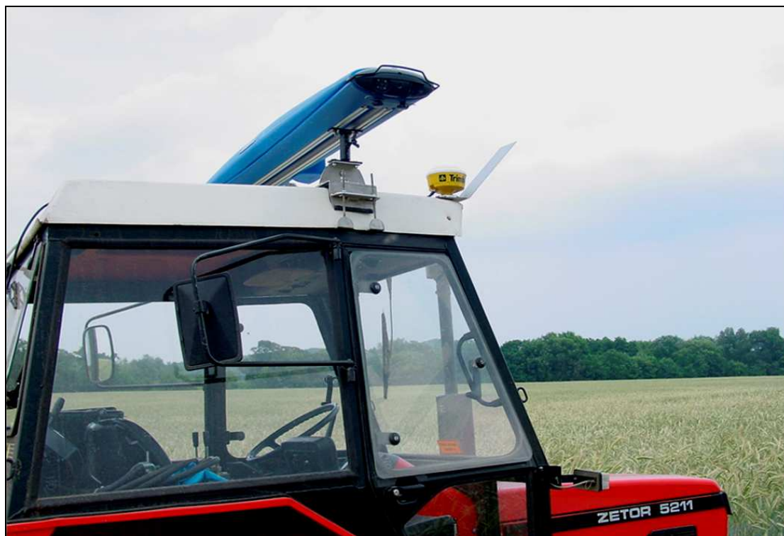
Figura 3. Sensor de reflectância (N-sensor), para adubação nitrogenada em taxa variável.
