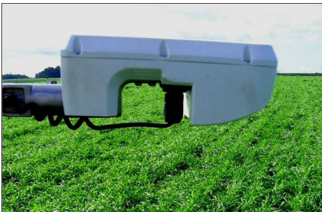
Figura 2. Sensor de reflectância (Greenseeker), para adubação nitrogenada em taxa variável.
